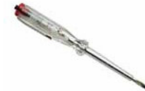
รูปภาพที่ 4 ไขควงตรวจสอบระบบไฟฟ้า ซึ่งเมื่อจิ้มที่แหล่งจ่ายไฟแล้วกดที่ปลายด้ามจะมีไฟสว่างขึ้นที่ตรงกลางด้าม
