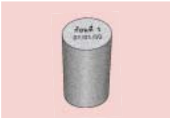
จ) ถอดแบบออก เขียนรายละเอียดของก้อนปูน แล้วนำไปบ่มในนํ้า
