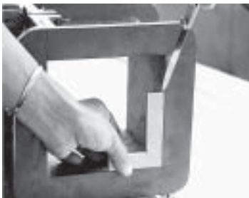
ข) การตรวจสอบมุมฉากของแบบหล่อรูปทรงลูกบาศก์
