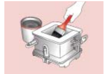
ก) ทำความสะอาดแบบหล่อ และทาน้ำมันภายในแบบให้ทั่ว
