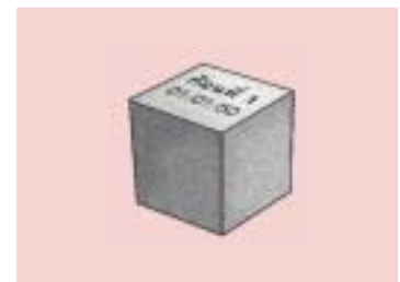
ฉ) ถอดแบบออก เขียนรายละเอียดของก้อนปูน แล้วนำไปบ่มในน้ำ
