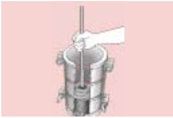
ข) ตักคอนกรีตใส่แบบ 3 ชั้น ให้มีปริมาณแต่ละชั้นเท่า ๆ กันแต่ละชั้นตํ่า 25 ครั้ง
