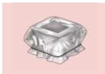
จ) คลุมด้วยแผ่นพลาสติกไว้เพื่อบ่มคอนกรีตในช่วงที่กำลังแข็งตัว
