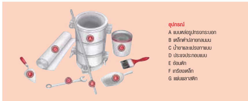
รูปที่ 15-14 อุปกรณ์ทำตัวอย่างคอนกรีตรูปทรงกระบอก
