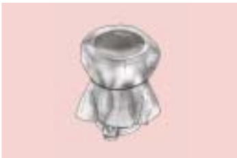
ง) คลุมด้วยแผ่นพลาสติกไว้ เพื่อบ่มคอนกรีตในช่วงที่กำลังแข็งตัว
